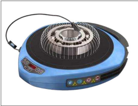
Fig. 1 – Campo magnetico attorno al cuscinetto
