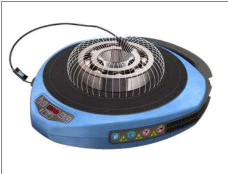
Fig. 1 – Campo magnético ao redor do rolamento
